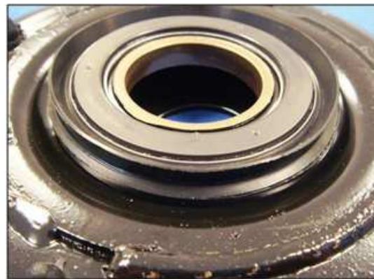
Installazione della guarnizione sul reggispinta
