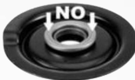
Respetar el sentido de montaje del tope: cara metálica no visible
