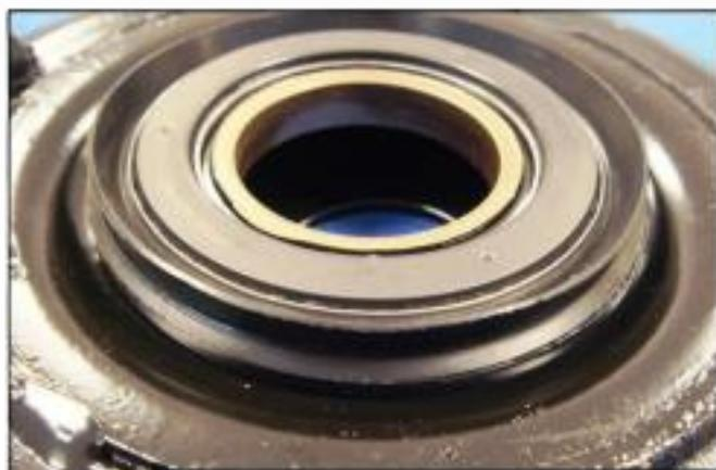
Montaje de la junta sobre el tope
