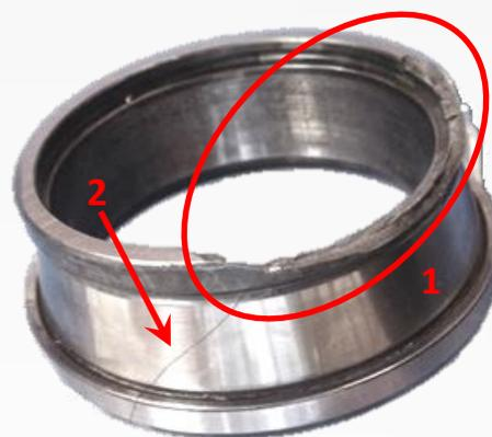
Des éléments peuvent alors passer dans les pistes du roulement, ce qui entraîne rapidement du bruit, puis conduit à la destruction du roulement.
