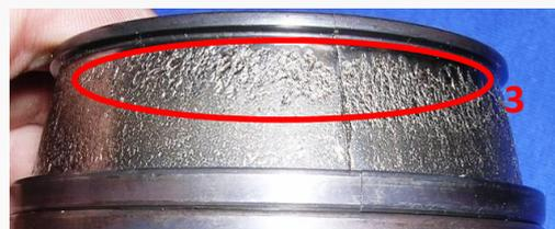
**Неправильная установка** Необходимо соблюдать рекомендации производителя по сборке подшипников и моментам затяжки. Для правильной регулировки подшипников могут понадобиться регулировочные шайбы. Несоблюдение всех рекомендаций и мер предосторожности приводит к преждевременному выходу из строя подшипников.
