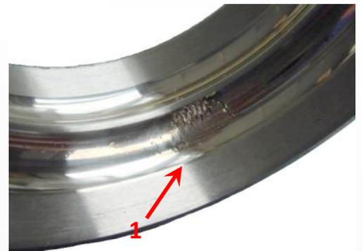
Der Einbau des Lagers verkehrt herum führt zu einer Fehlfunktion des ABS-Rechners (Fehlercode, ABS-Warnleuchte). Das Lager kann nicht ausgebaut und wiedereingesetzt werden. Bei der Montage des Lagers ist darauf zu achten, dass die Seite mit dem Magnetencoder getriebeseitig zeigt (d.h. zum Motor / Getriebe).
