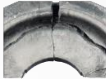
Defect schokdemperlager: Gebroken veerpootschotel
