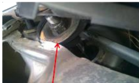
Inferieure veerpootlager en isolator constructie Zuigerstang is door het plaatwerk geslagen
