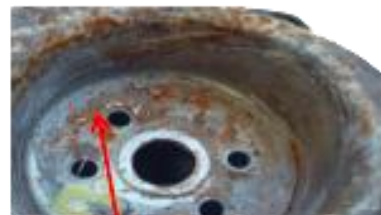
Corrosie die door het bewegen van de veer wordt veroorzaakt
