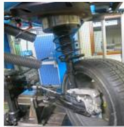
Testbank voor wielophanging in het NTN Europe Test Center
