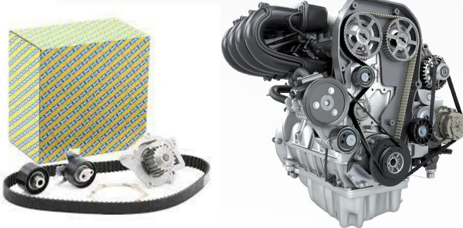
Il est important de ne pas négliger la relation entre la pompe à eau et le système d'entraînement via la courroie. Une courroie, un galet enrouleur ou galet tendeur usés ou mal installés causeront une défaillance de la pompe à eau, de même qu'une pompe à eau défectueuse ou mal installée peut entraîner la défaillance prématurée de la courroie quelle soit d'entraînement des accessoires ou de distribution moteur.
