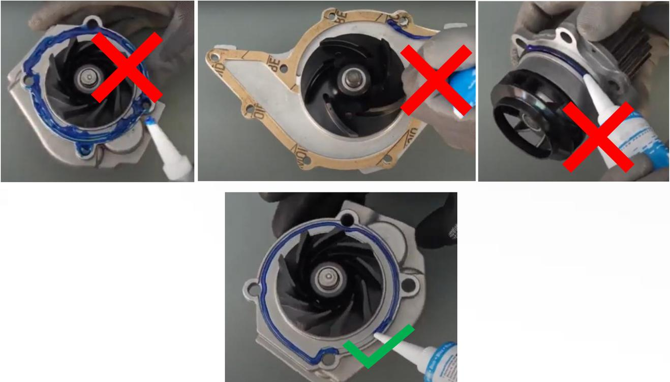
L'ajout de pâte d'étanchéité au niveau du plan de joint de la pompe peut entraîner facilement une mauvaise mise en place de la pompe à eau, voire endommager certains composants sensibles comme le joint interne de la pompe, provoquant ainsi des fuites de liquide de refroidissement.
