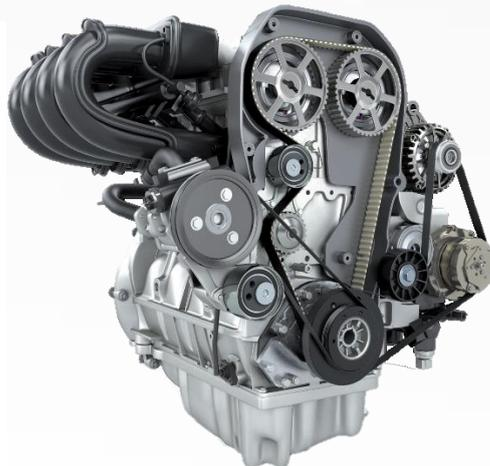
Non dimenticare il legame esistente tra pompa acqua e distribuzione trascinata da una cinghia. Cinghie, pulegge, tenditori usurati oppure installati in modo errato possono danneggiare la pompa acqua, proprio come una pompa acqua difettosa o installata in modo errato può causare il cedimento prematuro della cinghia sia per quanto riguarda la distribuzione motore che quella ausiliaria.
