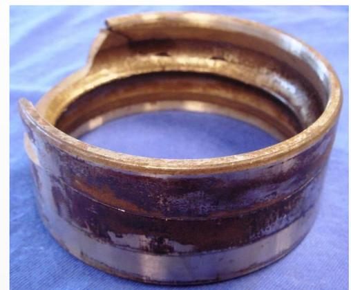
Pivote/eje desgastado e instalación sesgada
