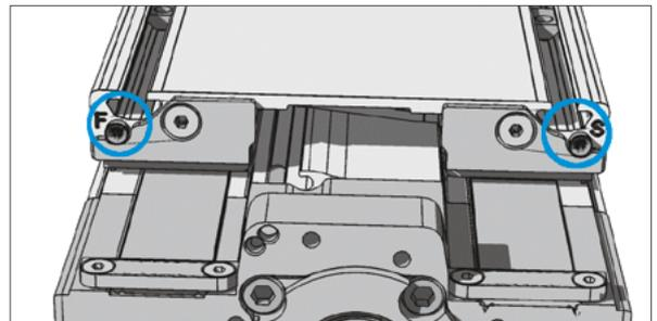
Bild 1.13 — Schlitteneinheit mit stirnseitigen Schmiernippeln
