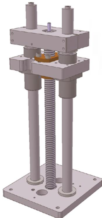
Der hier dargestellte Kugelbuchsenschisch ist eine Sonderkonstruktion nach Kundenvorgabe. Die Führung übernehmen zwei Wellen mit Mittelflansch-Kugelbuchsen. Antriebselement ist eine Trapezgewindespindel. Die Lagerungen des Gewindetriebs und die Aufnahme der Mutter integrieren gleichzeitig Funktionselemente der Kundenanwendung. Dadurch ergibt sich eine kostengünstige Lösung mit minimal bewegten Massen.
