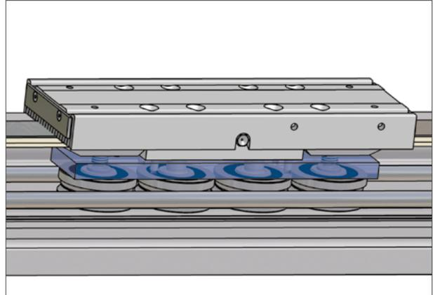
Bild 1.23 — SNR – Linearachse mit Laufrollenführung
