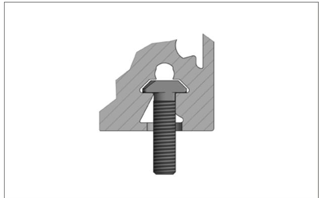
Bild 3.8 — Hammerschraube AXF
