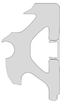
Bild 6.45 — Aluminiumabdeckprofil
