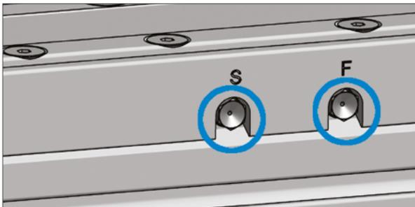
Bild 1.12 — Schlitteneinheit mit seitlichen Schmiernippeln
