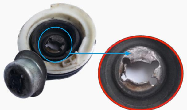
Einige Hersteller kopieren die Formen und Farben der Teile, damit sie für ein dem Originalteil gleichwertiges Teil gehalten werden. Aber da die Originaleigenschaften nicht beachtet werden (Wärmebehandlung, Metallverstärkungen...), kann der Einsatz dieser Produkte zur Folge haben, dass die Karosserie bei einem Schlag durchstoßen wird.
