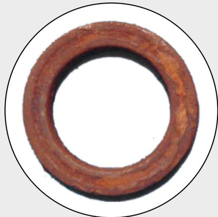
Durch eingedrungene Verunreinigungen korrodiertes
