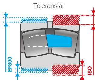
Standart serinin tolerans aralıklarına kıyasla dış çap ve silindirik/konik iç çaplar için daraltılmış olan toleranslar, bileziğin mükemmel bir şekilde oturmasını garanti eder.
