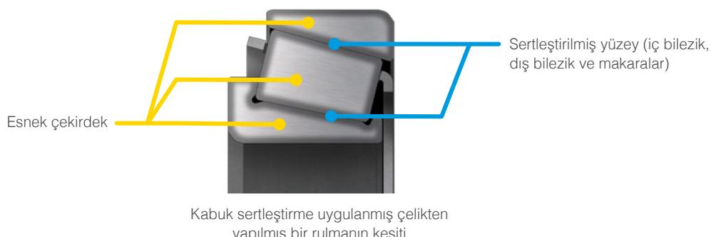
Kabuk sertleştirme uygulanmış çelikten yapılmış bir rulmanın kesiti
