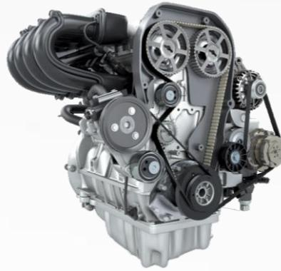
Es importante no pasar por alto la relación entre la bomba de agua y el sistema de la correa. Cuando una correa, un rodillo inversor o un rodillo tensor se desgastan o se instalan incorrectamente, es probable que se cause un fallo en la bomba de agua, así como una bomba de agua defectuosa o mal instalada puede causar un fallo prematuro del sistema de la correa, ya sea en los accesorios de la correa o en el sistema de temporizador.
