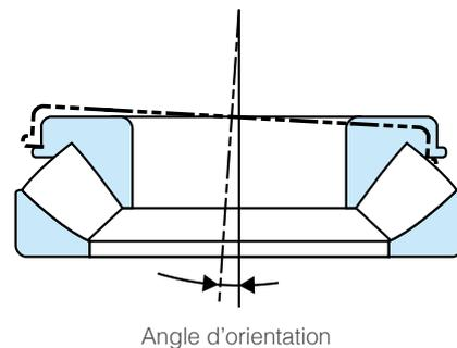
**Lubrification :** les butées à rotule sur rouleaux sont généralement fortement chargées et doivent être lubrifiées à l'huile. En raison de leur conception interne, la lubrification à la graisse n'est possible qu'à de faibles vitesses et charges modérées.
