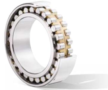
Les roulements à double rangée de rouleaux cylindriques sont conçus pour les applications à charges très élevées. Avec cages, ils offrent le meilleur compromis pour une vitesse de rotation modérée à élevée ; sans cage (type « full complement »), ils incorporent un nombre maximal de rouleaux pour une capacité de charge maximale.
