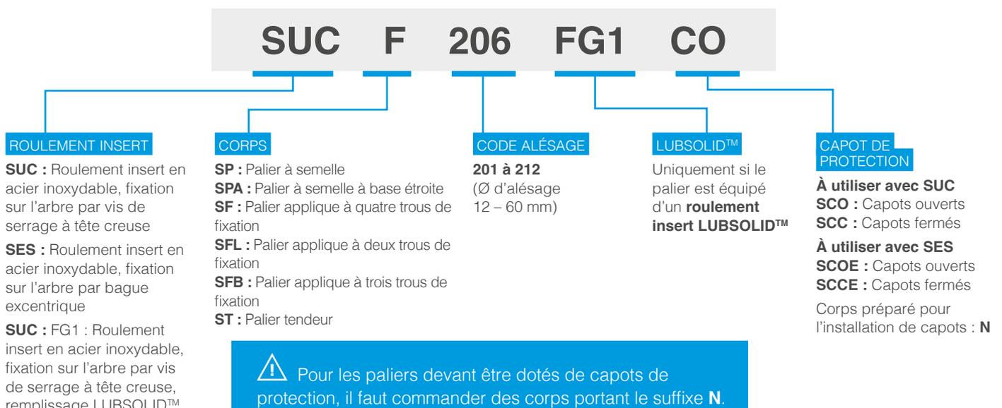
⚠ Pour les paliers devant être dotés de capots de protection, il faut commander des corps portant le suffixe **N**. Les paliers déjà commandés avec un ou plusieurs capots sont automatiquement livrés avec des corps rainurés.
