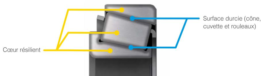
Section transversale d'un roulement en acier cémenté
