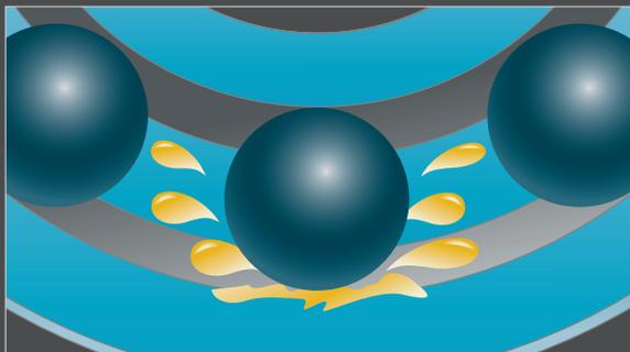
Sous l'effet des sollicitations mécaniques et thermiques, la graisse est laminée et chassée du contact corps roulant / piste de roulement. Cette perte impose de fréquents regraissages (cas des paliers auto-aligneurs).
