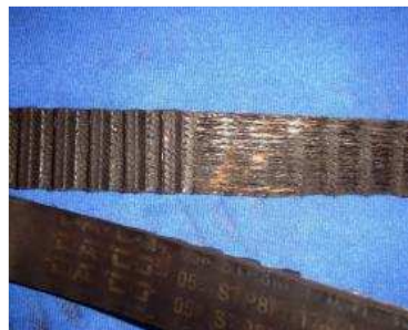
Usura dell'arresto inferiore del GT357.26
