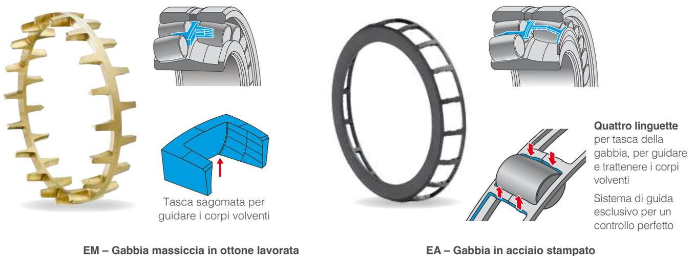
Questo design vincente elimina la necessità di un anello di guida centrale, offrendo numerosi vantaggi:
