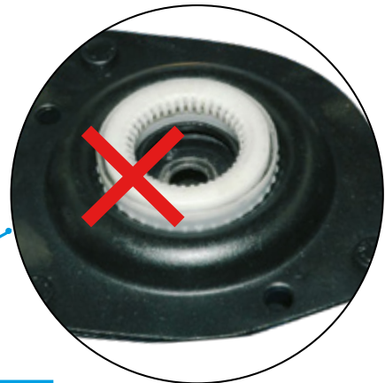
Falsche Montage Drehen der Lenkung beeinträchtigt
