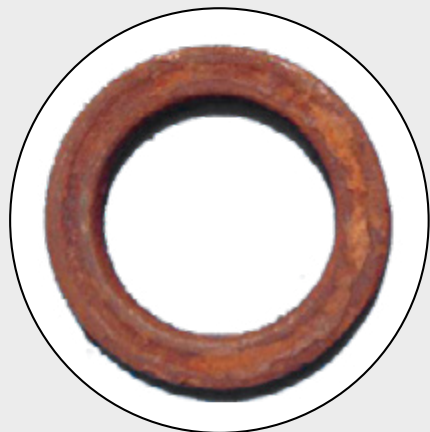
Durch eingedrungene Verunreinigungen korrodiertes Federbeinstützlager
