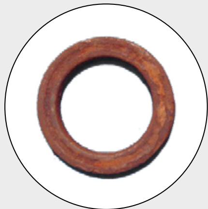
Tope de suspensión con corrosión debido a la entrada de contaminación
