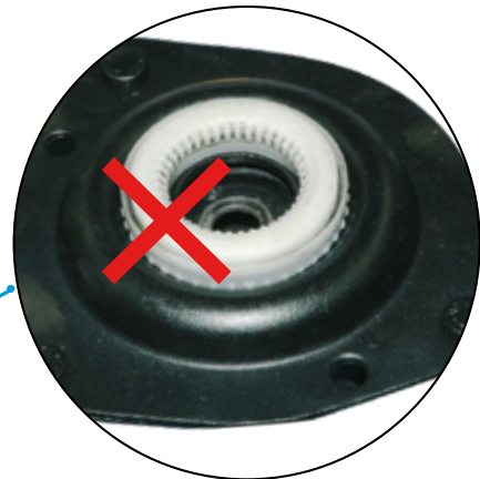
Mauvais montage Rotation de la direction entravée
