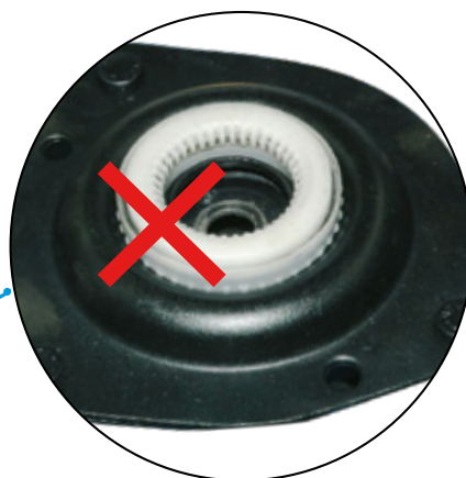
Errato montaggio Rotazione dello sterzo ostacolata
