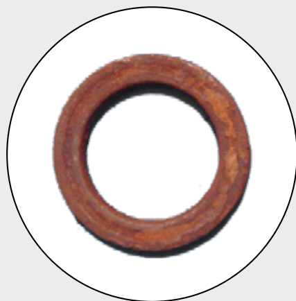
Reggispinta sospensione intaccata a seguito dell'ingresso di contaminanti
