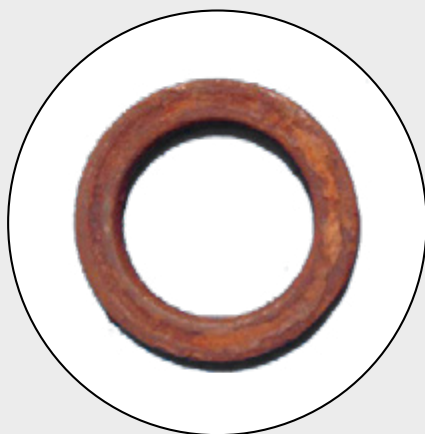
Gecorrodeerd veerpootlager na het binnendringen van vervuiling
