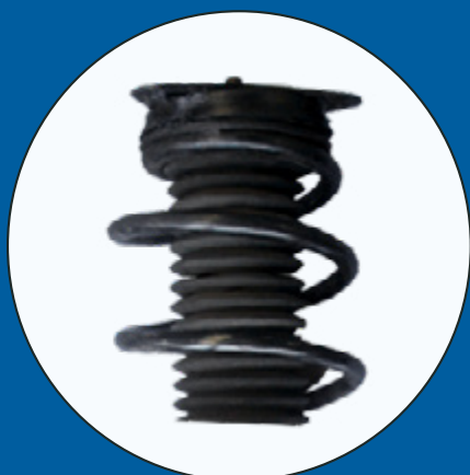
Zniszczona poduszka zawieszenia
