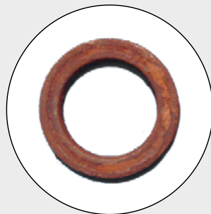
Łożysko zawieszenia skorodowane na skutek wnikania zanieczyszczeń
