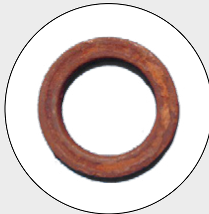
Коррозия опорного подшипника вследствие воздействия загрязнителей
