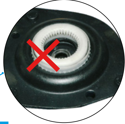
Yanlış montaj Direksiyon sisteminin dönüşü bozulur
