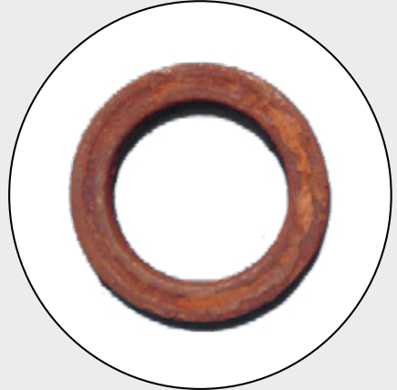
Kir girişi nedeniyle korozyona uğramış amortisör rulmanı
