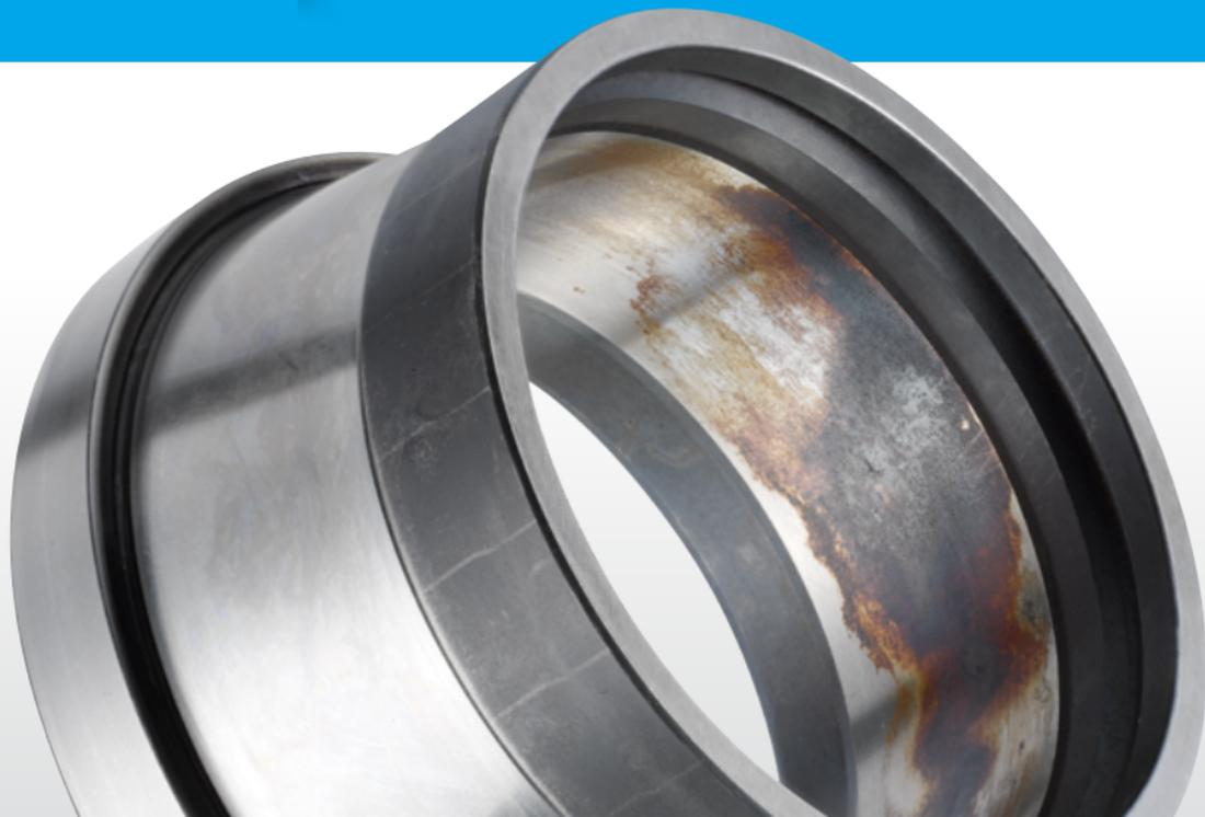
Ein Wälzlager ist ein Bauteil, das der Ermüdung unterliegt. Auch bei noch so genauer Geometrie und trotz Verwendung von Hochleistungsstählen: Ein Wälzlager hat eine begrenzte Lebensdauer. Tatsächlich führt die Belastung des Wälzlagers zu Ermüdungserscheinungen des Materials, die seine Lebensdauer begrenzen. Des Weiteren kann eine Vielzahl von zusätzlichen äußeren Faktoren das Funktionsverhalten negativ beeinflussen und zu vorzeitigem Ausfall führen.
