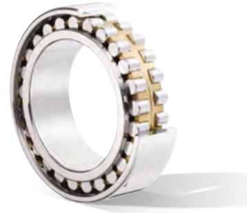
Os rolamentos de rolos cilíndricos de duas carreiras são projetados para aplicações de carga muito pesada. Com gaiolas, eles oferecem o melhor compromisso para velocidade de rotação moderada a alta; sem gaiolas (Tipo complemento total), eles incorporam o número máximo de rolos para a capacidade máxima de carga.
