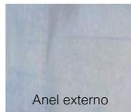
Menos deterioração do rolamento após um tempo de operação que durou o **dobro**
