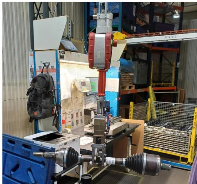
La zone de contrôle / emballage a elle aussi été équipée d'une aide à la manutention afin de faciliter le travail des opérateurs et donc de réduire le port de charge. Constituée d'un portique mobile standard et d'un préhenseur spécifique développé en interne, il répond aux attentes de nos collaborateurs. Fort de son succès et du bon retour de ce prototype, la solution va être dupliquée pour mise en place sur les 3 autres postes qui constituent cette zone de travail.
